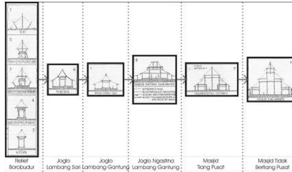
**Gambar 7. Asal-usul Perkembangan Struktur Bangunan Masjid Tumpang (Sumber: Pont dalam Wiryoprawiro, 1986)**
