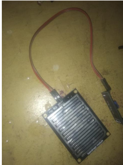
Gambar 4.3 Pengujian Sensor Hujan Sumber : Penelitian Mandiri 2021
