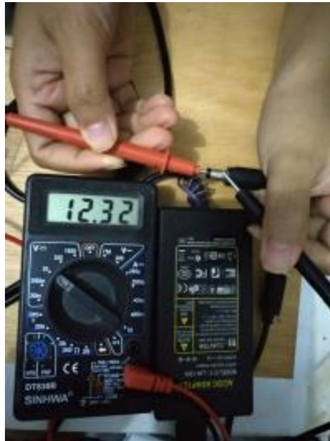
Gambar 4.1 Pengukuran Tegangan Output Adaptor Sumber : Penelitian Mandiri 2021
