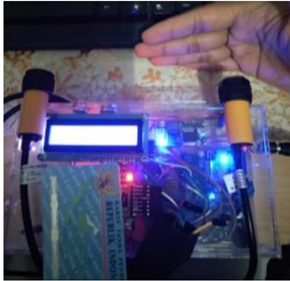
Gambar 4.5 Pengujian Sistem Deteksi Sensor Proximity 1 Sumber : Penelitian Mandiri 2021
