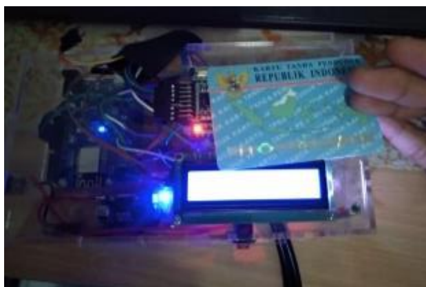
Gambar 4.4 Proses Pengujian Data E-KTP dengan Output Berupa LCD 16x2 Sumber : Penelitian Mandiri 2021
