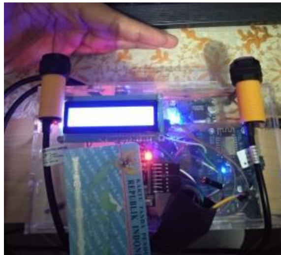
Gambar 4.6 Pengujian Sistem Deteksi Sensor Proximity 2 Sumber : Penelitian Mandiri 2021
