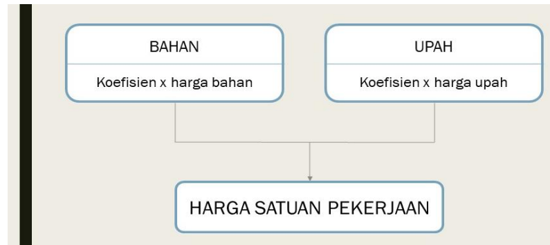
Gambar 2.3. Skema Analisis Harga Satuan Pekerjaan Sumber : Internet
